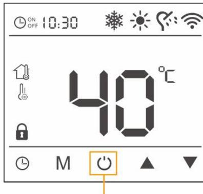
Kurzes Drücken schaltet das Gerät ein/aus
