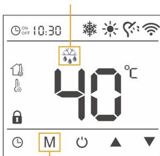
Maintenez enfoncé pendant 3 secondes en état allumé du contrôleur et en mode de chauffage
